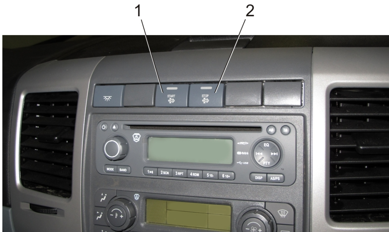
Рис. 3.11. Панель приборов: 1 – выключатель регенерации сажевого фильтра; 2 – выключатель запрета регенерации сажевого фильтра
