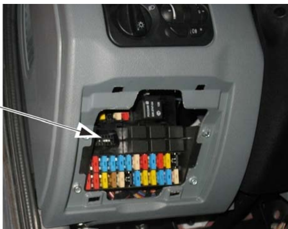
Рис. 3.8. Диагностический разъем системы управления двигателем
