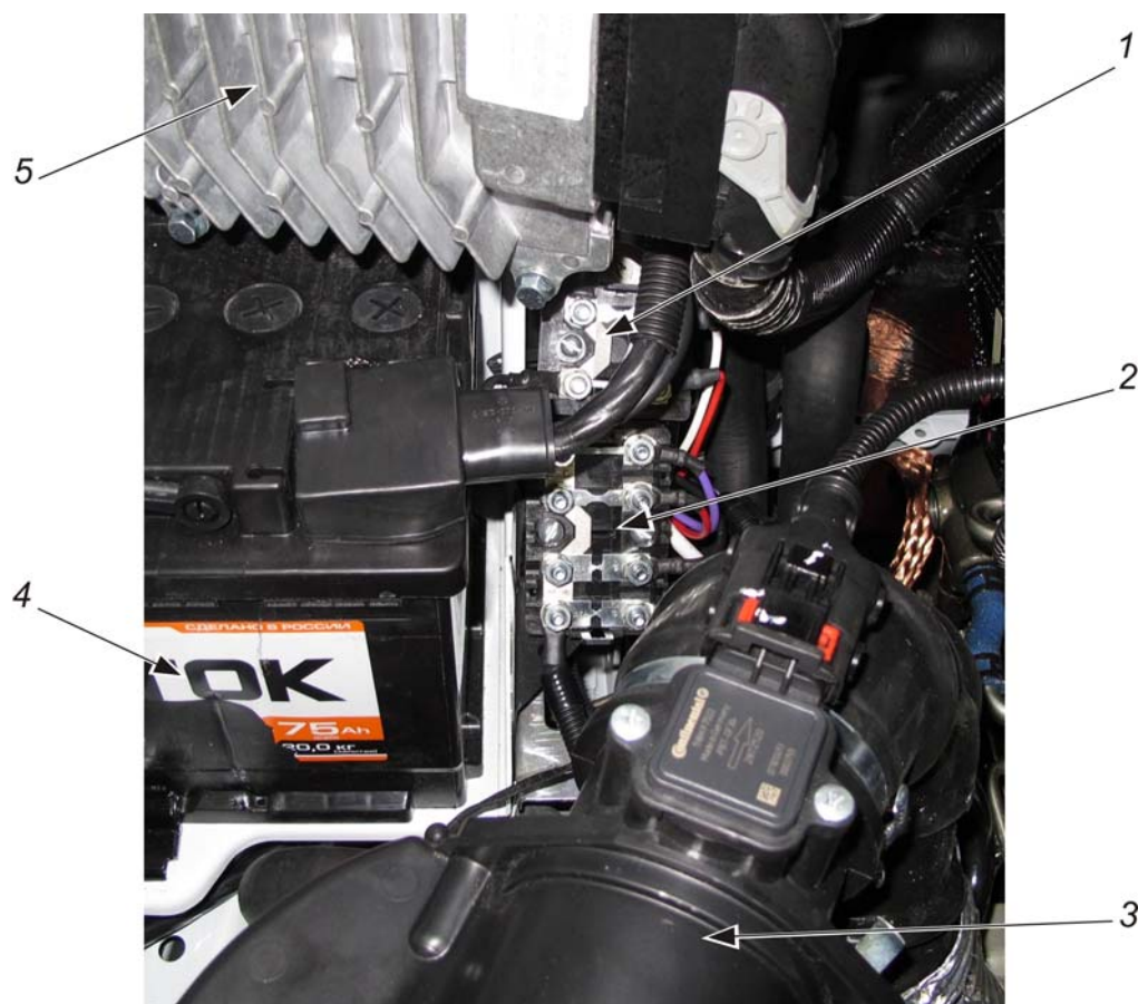
Рис. 3.4. Установка блоков предохранителей: 1 – блок предохранителей БПР-2М8 1) ; 2 – блок предохранителей БПР-4.10; 3 – воздушный фильтр; 4 – аккумуляторная батарея; 5 – блок управления двигателем
