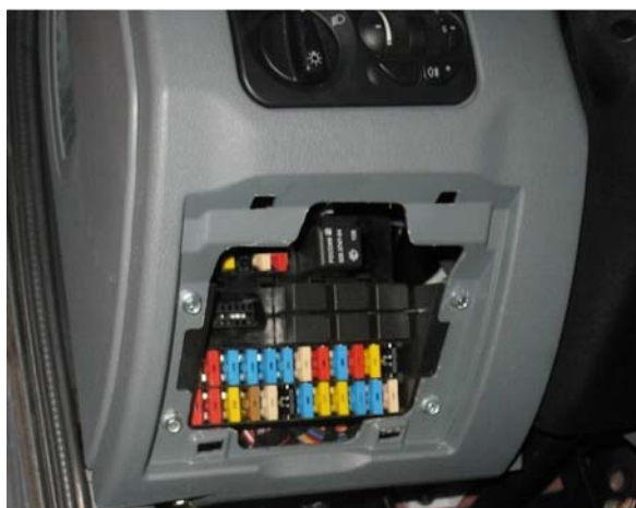
Рис. 3.5. Блок реле и предохранителей
